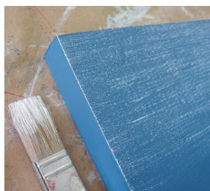
5. Con un pennello vecchio o di setola dura e Sugar ben scaricato tracciate delle pennellate nel senso della venatura del legno.
